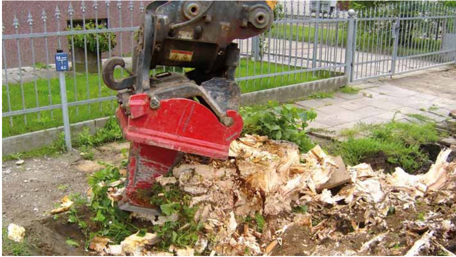
Durch den Einsatz der Wurzelratte wird die Rodungszeit verkürzt und der Wurzelstubben automatisch grob zerkleinert. | Fotos: Wurotec
