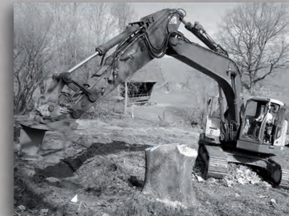
Die Wurzelratte W 30 an einem 25-t-Bagger.
